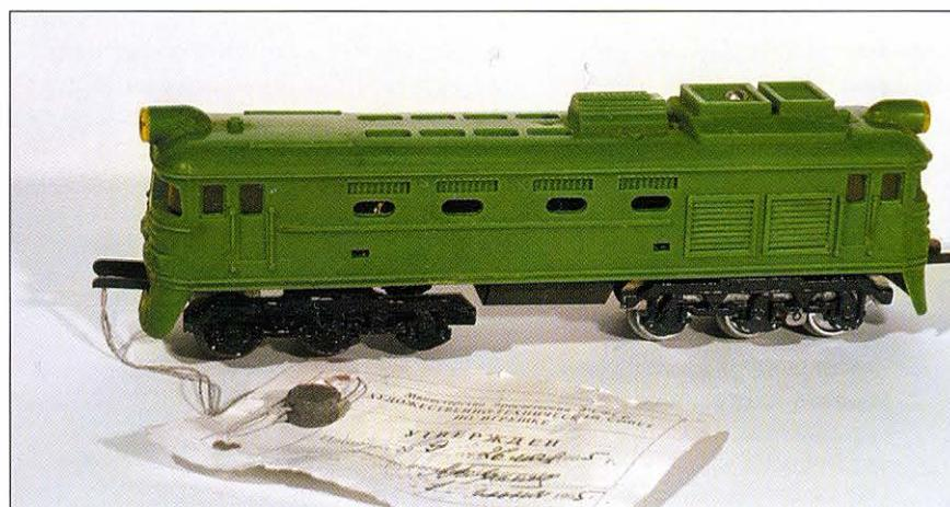
лические колеса размещались справа по ходу, а на другой — слева. Таким образом, электрический ток проходил с одного рельса через металлические колеса первой тележки и раму тележки на электродвигатель, а далее — по изолированному проводу на раму второй тележки и через металлические колеса на второй рельс.
