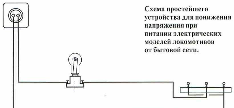
Схема простейшего устройства для понижения напряжения при питании электрических моделей локомотивов от бытовой сети.
