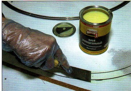
**Приклеиваем шумоизолирующее основание балластной призмы из листовой пробки по разметке.**
