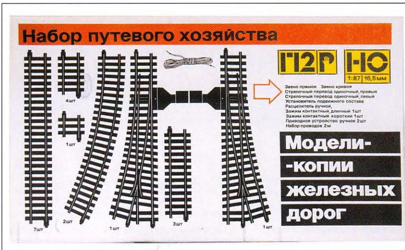
тевого материала. Это были различные рельсовые звенья, а также стрелки с цельнокатанными профильными рельсами высотой 2,5 мм, полностью совместимые со всеми мировыми образцами, имеющими такую же высоту рельсов.
