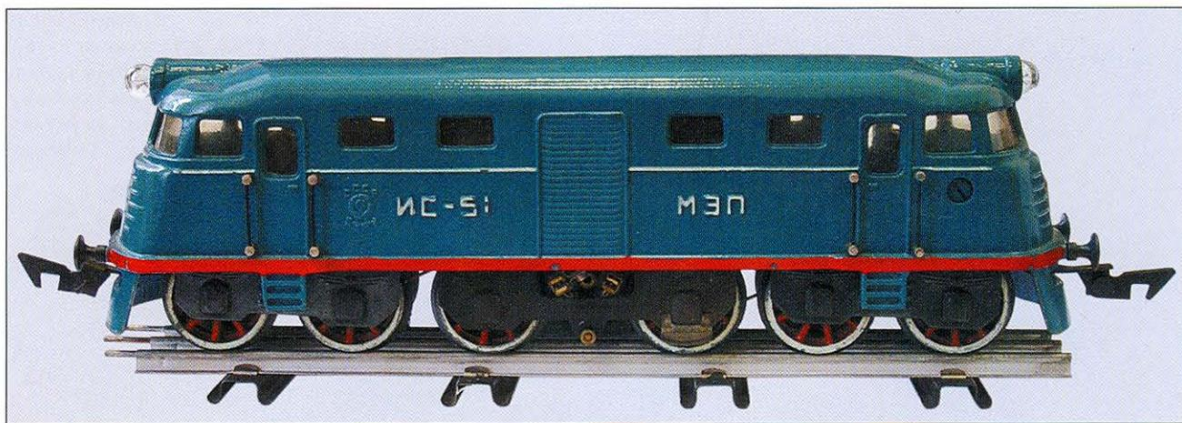
**Локомотив «Электрической железной дороги» имел литой металлический кузов. Токосъем происходил со среднего рельса специальными токоприемниками.**
