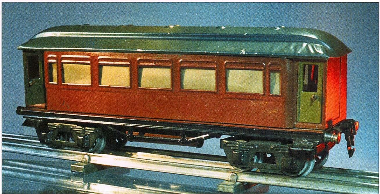
случаев схода с рельсов. Широкие окна, открывающиеся и запирающиеся двери, зауженные по отношению к ширине вагона тамбуры, внутренне обустраивство, двухуровневая крыша, две двухосные тележки, спицованные колеса, наличие шпренгелей и двух больших подвагонных цилиндров, никелированные буферные устройства — все эти многочисленные достоинства мо-
