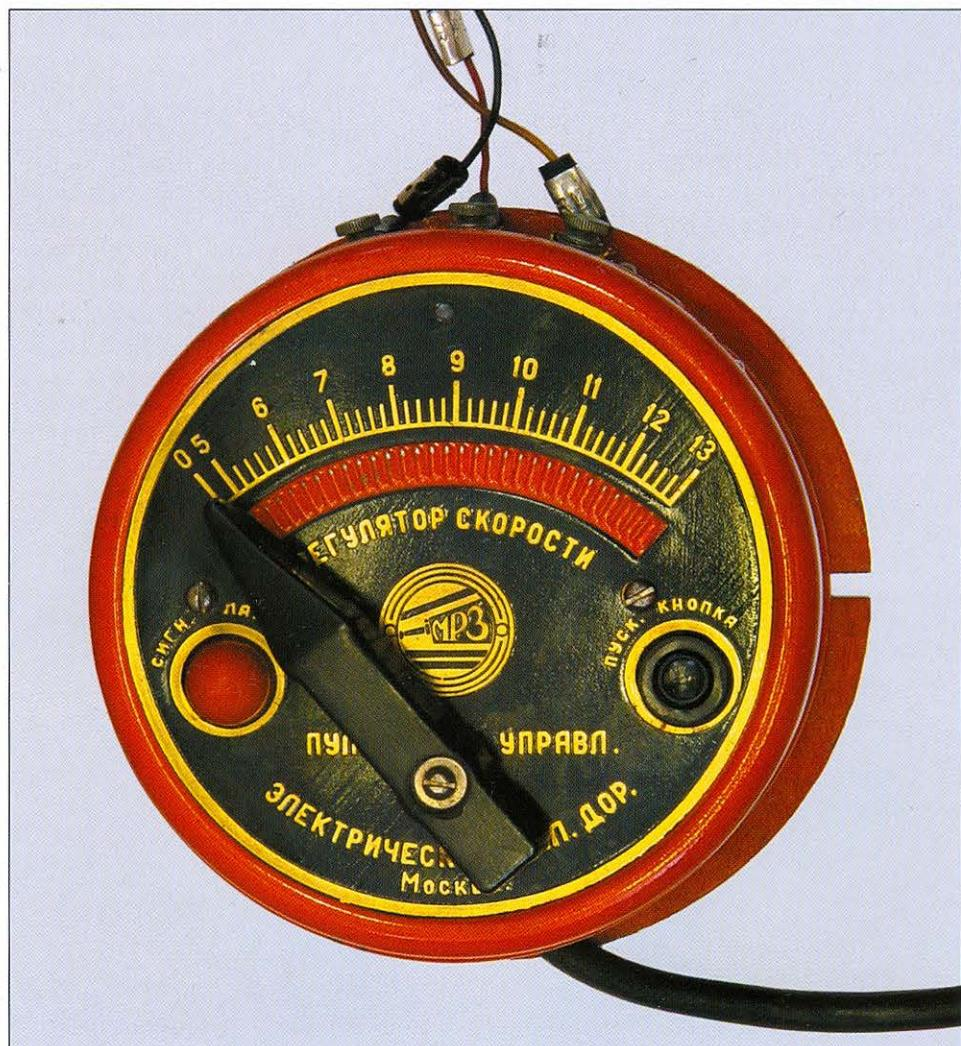
новок постоянного нерегулируемого напряжения (13,5 В). Скорость движения локомотива изменялась плавным поворотом ручки регулировки напряжения.
