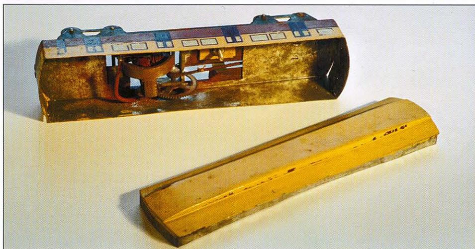
Вагоны набора «Метро» изготавливались из белой жести и окрашивались вручную. Привод вагона имел оригинальную конструкцию редуктора, в первой ступени которого располагались шестерни, а вторая ступень была ременной.
